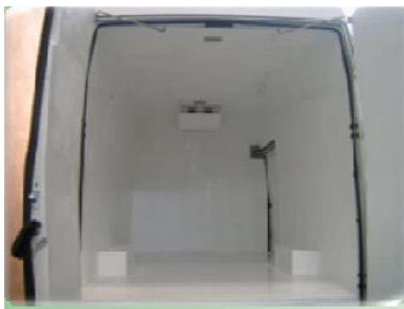
Figura 9 – Revestimento sobre isolamento térmico
